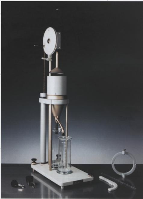
Das Mahlungsgradprüfgerät SR 1 dient zur Bestimmung der Entwässerungsgeschwindigkeit von Papier-, Holz- und Holzschleifstoffen. Dieser Apparat gestattet, zuverlässig festzustellen, wie schnell der Papierstoff auf dem Sieb entwässert und ermöglicht eine sichere Beurteilung der Stofffeinheit, da Entwässerungsgeschwindigkeit und Zerkleinerungszustand des Fasermaterials in enger Wechselbeziehung stehen.
