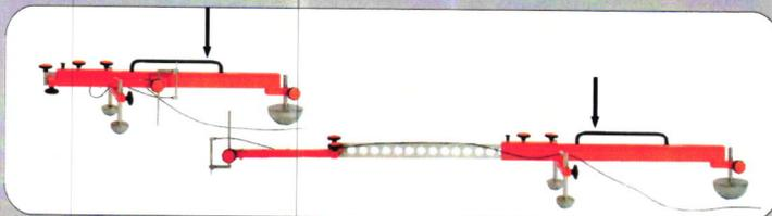
Der Tragegriff ermöglicht den Transport der Messbrücke, wenn diese zusammengeklappt<sup>(1)</sup> oder aufgebaut<sup>(2)</sup> ist.
