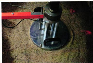
Gefordertes Mindestquantil  $E_{v2}$ :  $\geq 45 \text{ MN/m}^2$  Gefordertes Höchstquantil  $E_{v1}/E_{v2}$ :  $\leq 2,2$
