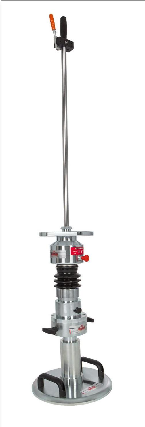
Abbildung 1: CBR Geräteanordnung Feldversuch mit 10 kg Belastungsvorrichtung
