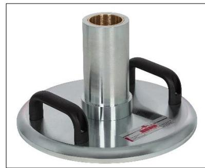
Abbildung 4: Belastungsplatte mit Stempelführung
