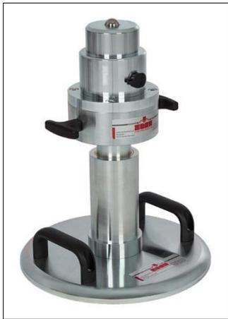
Abbildung 7: Geräteanordnung CBR Feldversuch
