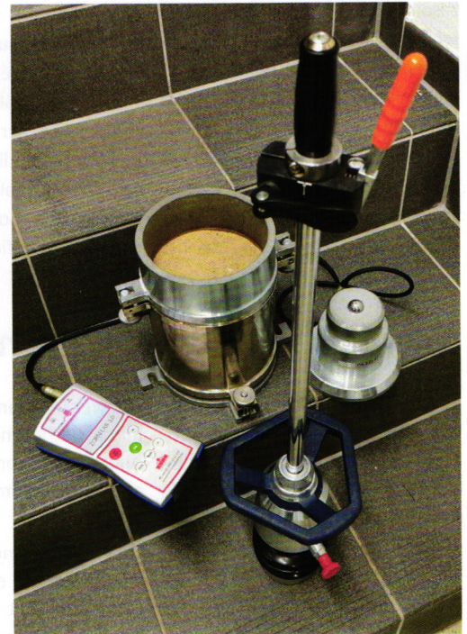
Bild 2: Mit der Laborvariante der Fallgewichtsgeräte lassen sich Materialproben im Labor auf straßenbauliche Eignung zu prüfen
